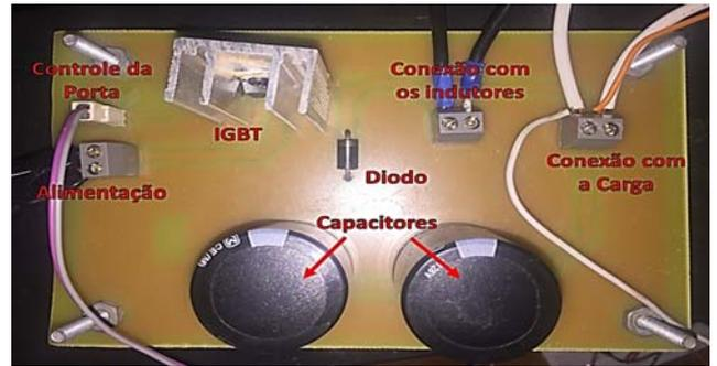
Fig. 6. Placa do conversor CC-CC do tipo Buck desenvolvido.
